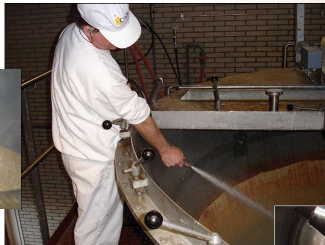
De CyberJet reinigt met 50 graden water
